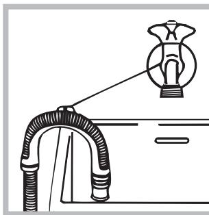
или поместите шланг в раковину или в ванну, закрепив прилагающуюся направляющую к крану (см. схему). Свободный конец сливного шланга не должен быть погружен в воду.
